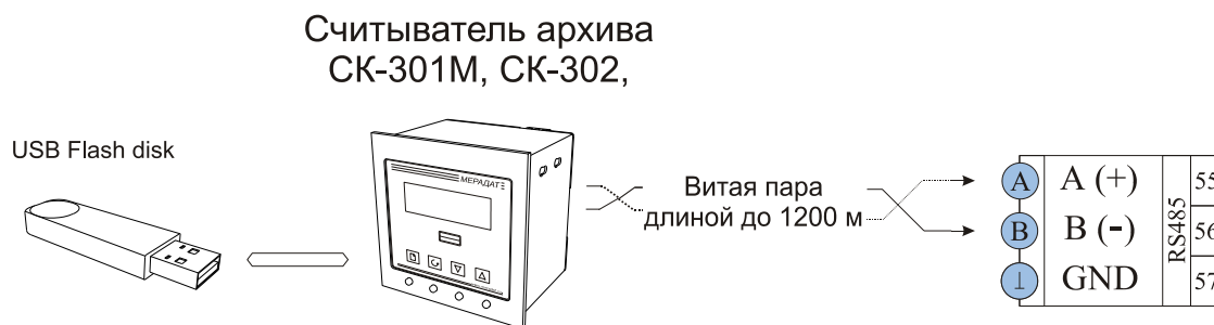
Рис 5.4 Типовая схема подключения прибора к считывателям архива.
