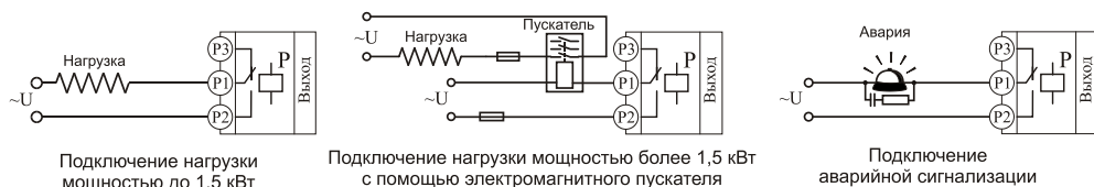
Рис.1 Использование релейного выхода
