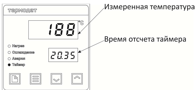
Рисунок 4 - Внешний вид прибора с включенным таймером
