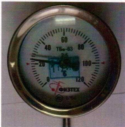
Рисунок 5 – Место нанесения знака поверки на стекло
