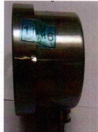
Рисунок 6 – Место нанесения знака поверки на место соединения обечайки и корпуса
