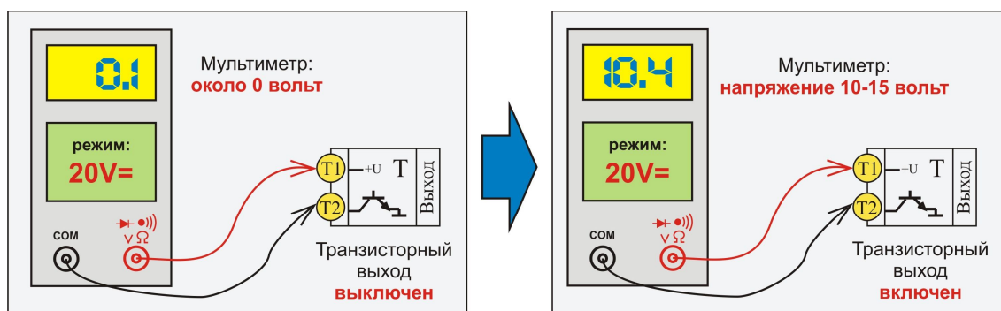
рис 19. Проверка симисторного выхода мультиметром.
