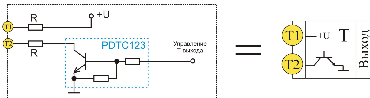
рис 11. Внутреннее устройство транзисторного (Т) выхода.
