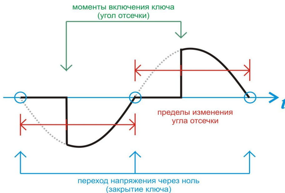
рис 14. Принцип фазоимпульсного метода регулирования.
